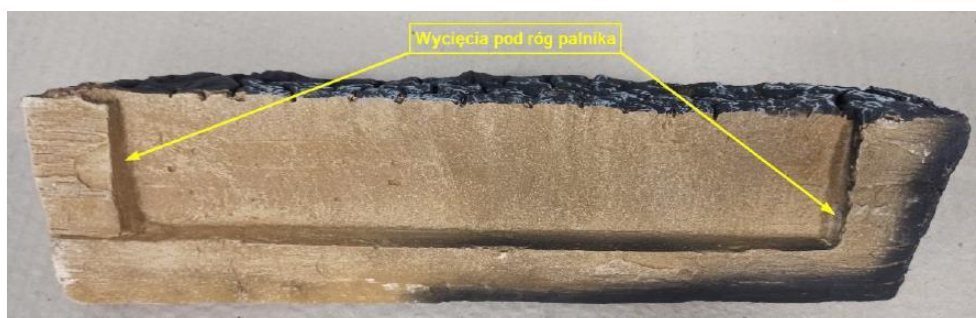
Rysunek 31. Wcięcia w elementach 2 i 3, które ułatwiają ułożenie na rogach palnika.
